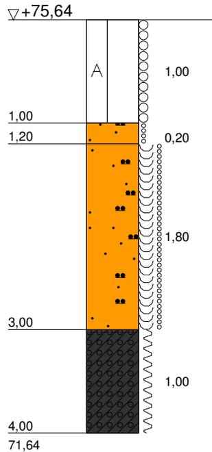
1,00 Auffüllung (Mutterboden, S, u+, o), schwach feucht, locker, [OH], 1, dunkelbraun
