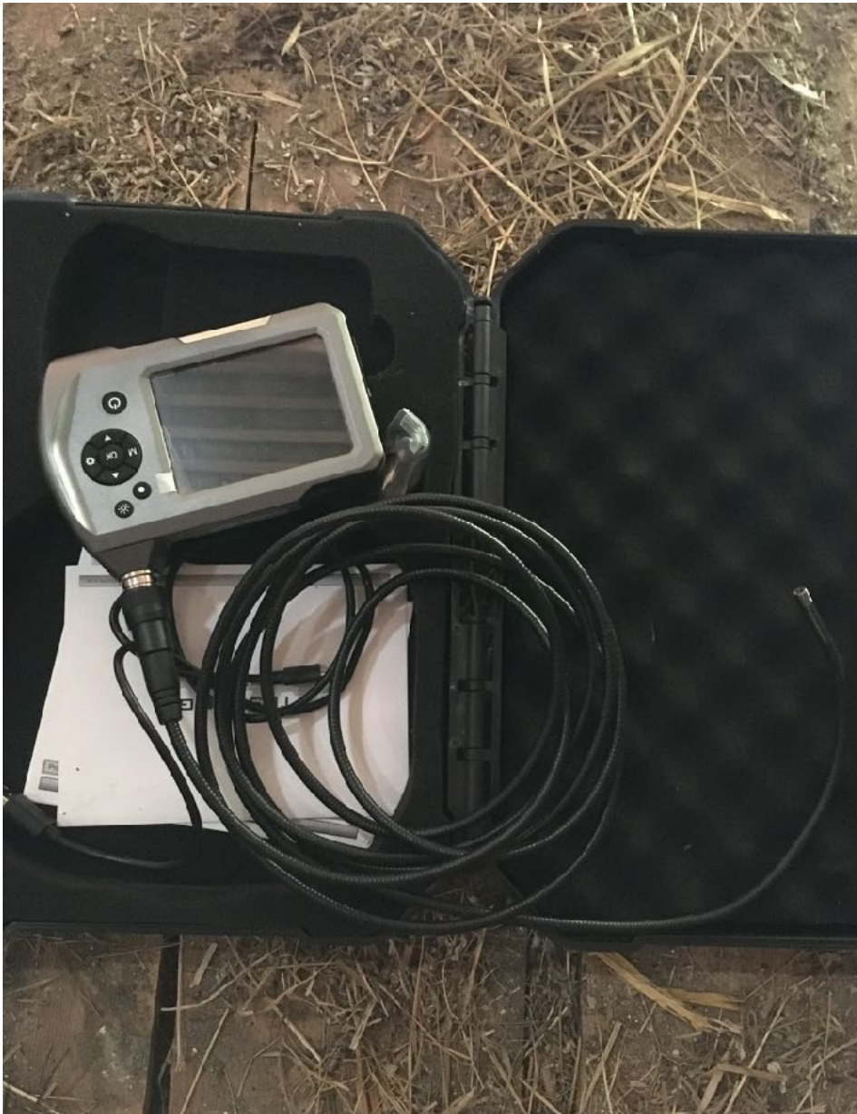
Abb. 6: Foto von der Endoskop-Kamera, die zum Einsehen von Spalten und Nischen benutzt wurde
